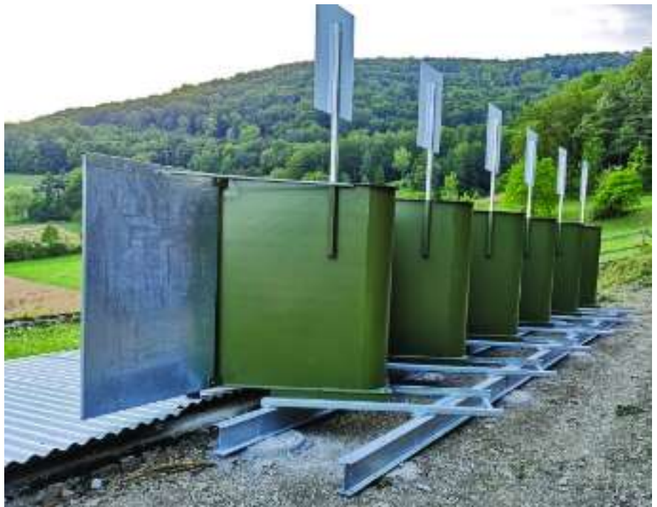
Kugelfang von hinten mit optimierter Abfangvorrichtung.
